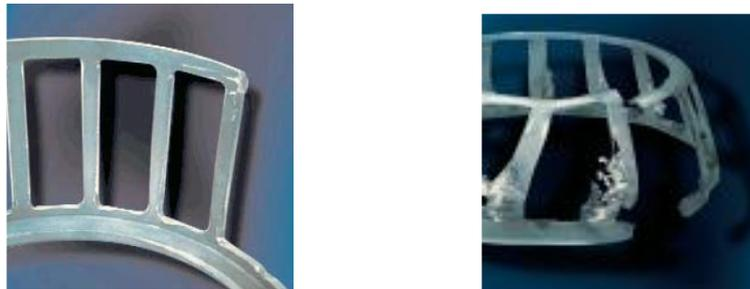
**Figure 1.17** - Rupture de la cage
