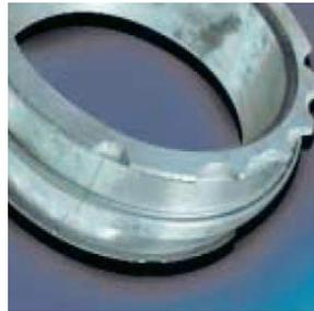
**Figure 1.14** - Ruptures dues à un montage avec coups
