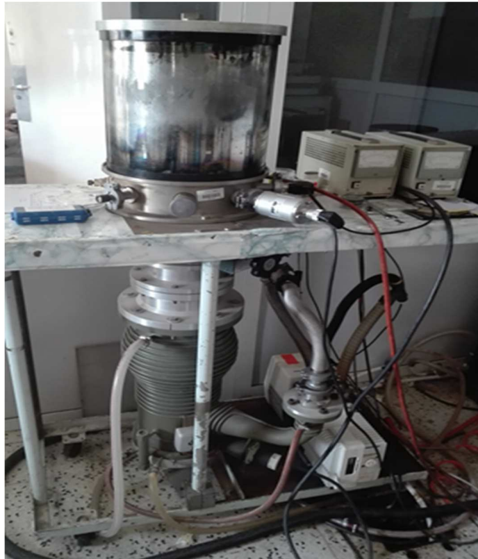
Figure III.9 : Groupe de dépôt par évaporation sous vide utilisé et installé au CRTSE.
