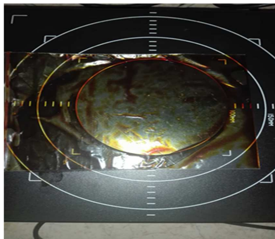
Figure V.6 : Plaquette trempée dans une solution de passivation d'Iodine-Ethanol durant les mesure de \tau_{\text{eff}} .
