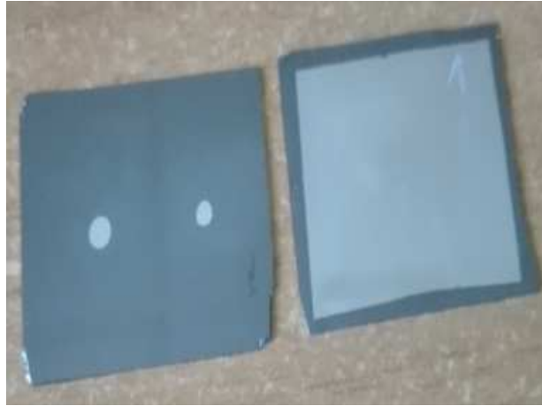
Figure III.10 : Structures Schottky Ag/p-Si/Al élaborées par dépôt d'Aluminium en face arrière et Argent en face avant.
