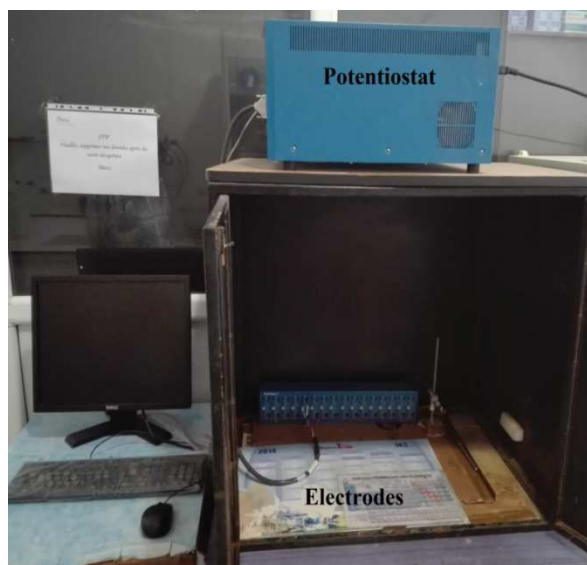
Figure III.11 : Le banc servant à la caractérisation par spectroscopie d'impédance, monté à partir d'un potentiostat.
