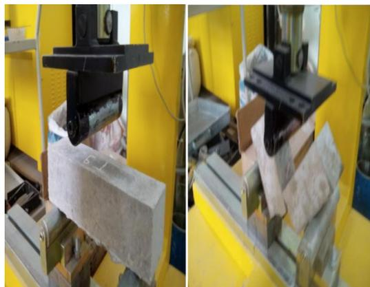
**Figure III. 15 :** L'essai de la résistance à la flexion.
