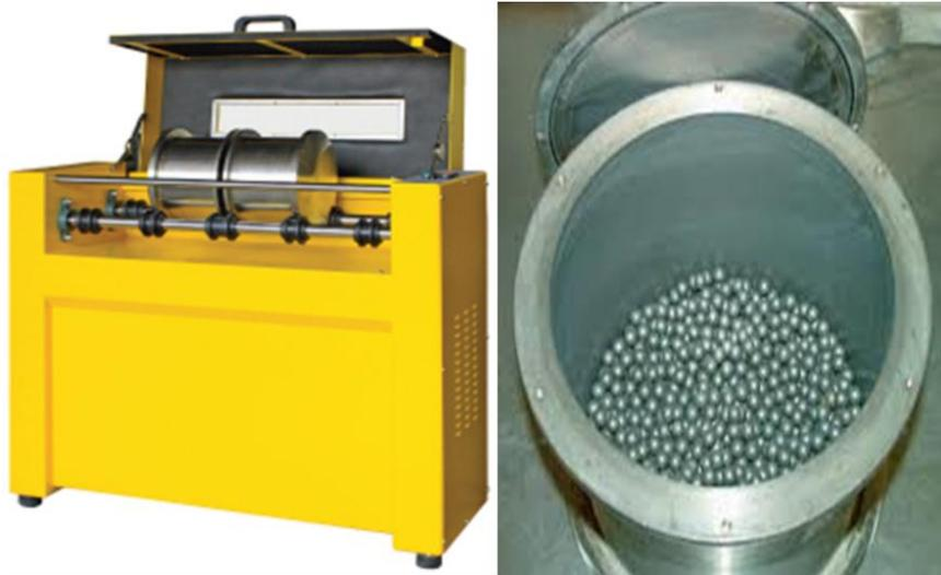
**Figure III. 8 :** Machine d'essai Micro Deval.
