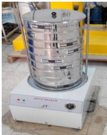
**Figure III. 4 :** Equipement de l'analyse granulométrique.
