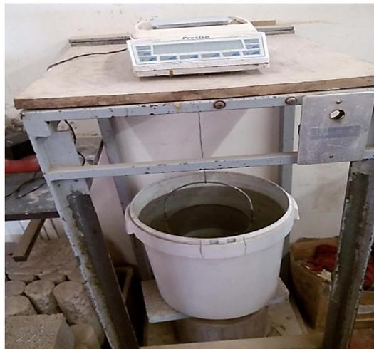
**Figure III. 20** : Mesure de la masse hydrostatique des échantillons du béton.
