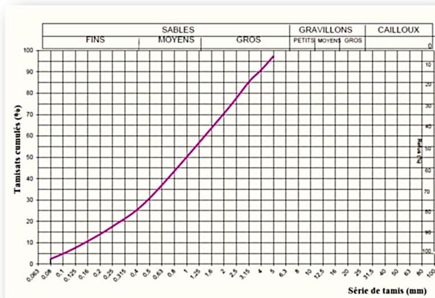
**Figure III. 5 :** La courbe granulométrique du sable.
