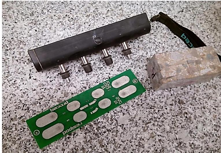
Figure III. 22 : Essai de résistivité électrique.
