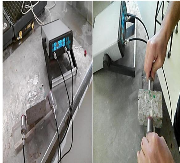
**Figure III. 23 :** Essai de vitesse de propagation des ultrasons.
