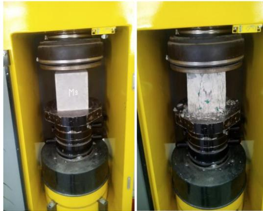
**Figure III. 14 :** L'essai de la résistance à la compression.
