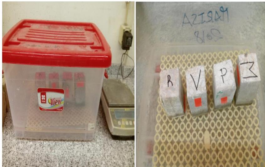
**Figure III. 19 :** Essai d'absorption d'eau par capillarité.
