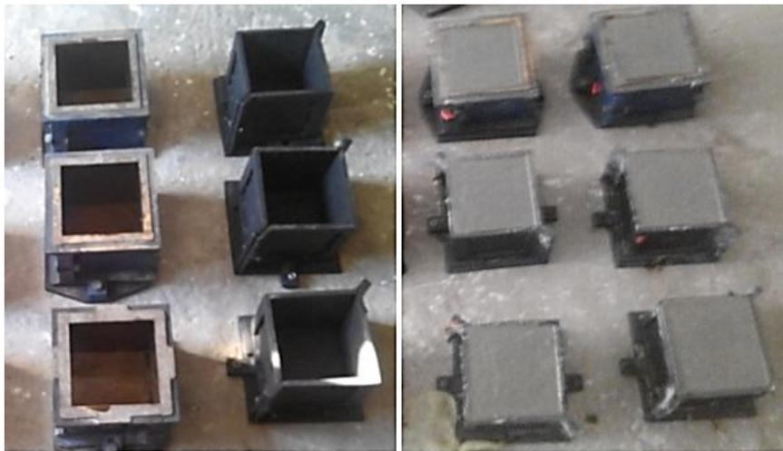
**Figure III. 12 :** Les échantillons pour mesurer la masse volumique à l'état frais.
