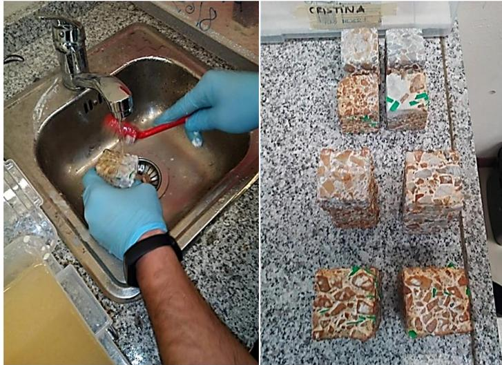
**Figure III. 24** : Essai l'attaque d'acide sur les échantillons du béton.
