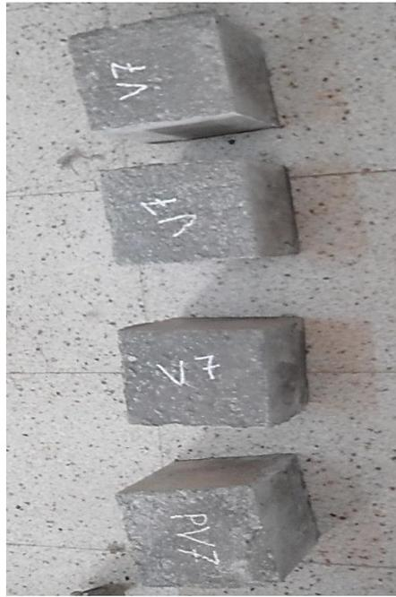
**Figure III. 13 :** La détermination de la masse volumique des bétons à l'état durci.
