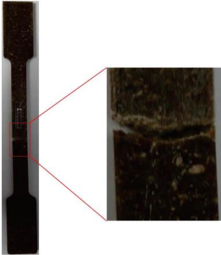
Figure IV-5: Zone de rupture d'une éprouvette à 40% d'ajout de farine de bois
