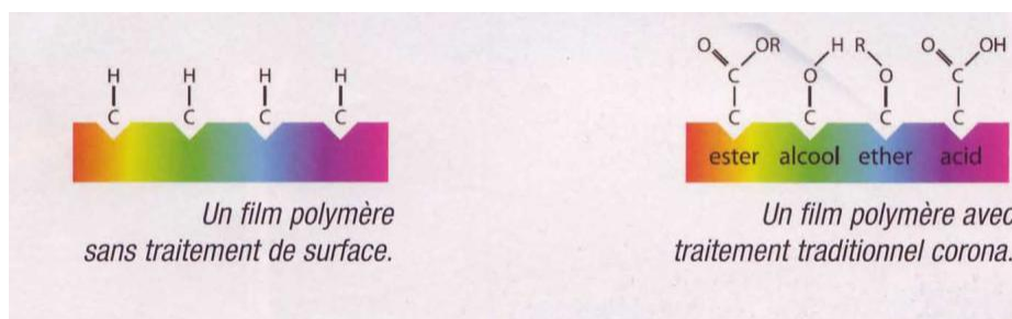
Figure II-11. Effet "Corona" (activation de la surface d'un polymère par oxydation)
