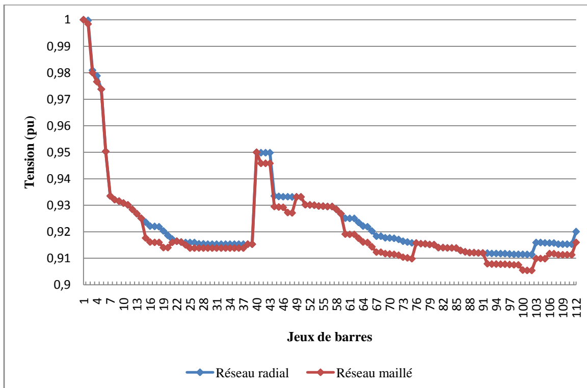
Figure 3.20 : Comparaison des niveaux de tension pour le réseau 112-bus radial et maillé
