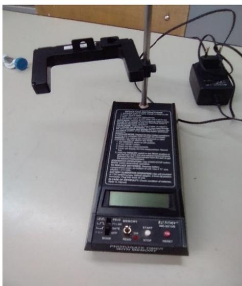
Figure 4-31: Dispositif de mesure de la vitesse Photogate.
