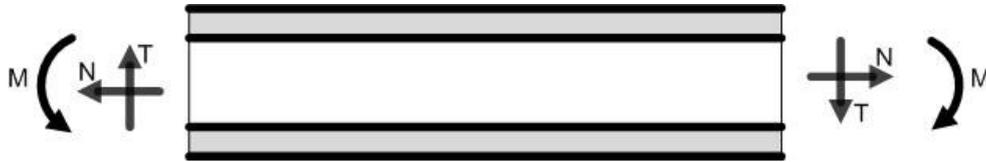
Figure 1-18: Différentes sollicitations des panneaux sandwichs.
