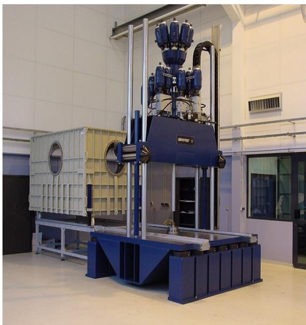
*a- Machine hydraulique de chocs.*
