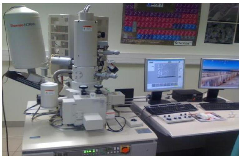
**Figure II.5 :** Microscopie électronique à balayage (MEB) type E3 Electroscan.
