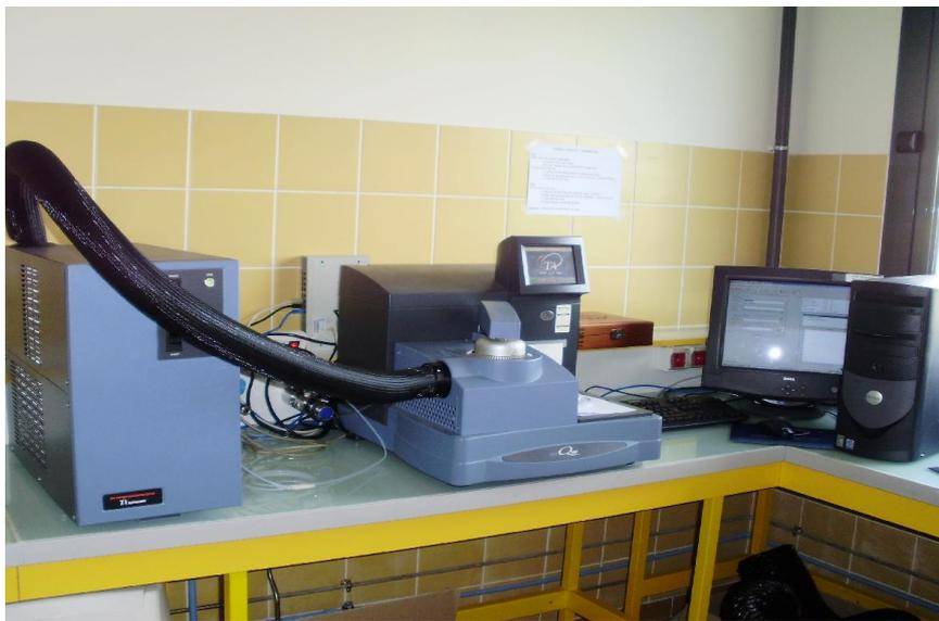
*Figure II.9 : Calorimétrie différentielle à balayage (DSC).*
