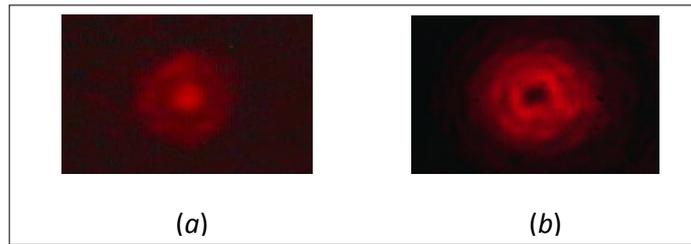
*Figure III.19 : Images représentatives de la diffraction d'un faisceau gaussien à travers un trou de phase de diamètres : (a)  $2\rho_0=500\mu\text{m}$ , (b)  $2\rho_0=800\mu\text{m}$ .*
