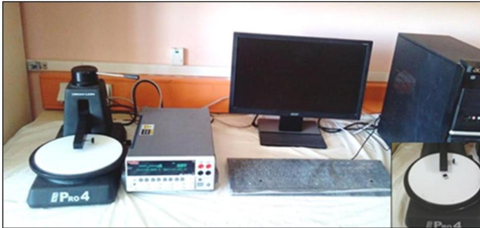
**Figure 6 :** Dispositif expérimental utilisé pour mesurer la conductivité électrique par la méthode de quatre pointes.
