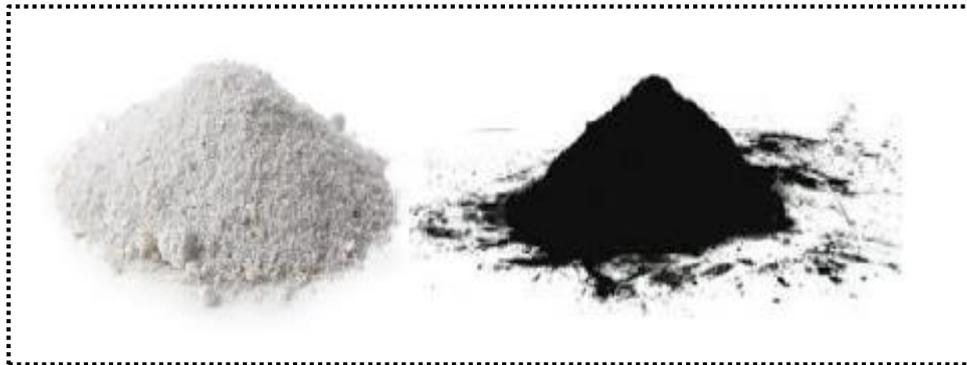
Figure IV.1 : Poudre de chamotte (à gauche) et de carbone (à droite)
