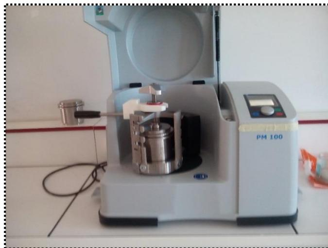
**Figure IV.6 :** Broyeur PM100 à bille d'alumine
