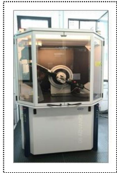
**Figure IV. 16 :** Diffractomètre de type Bruker D8-Advance
