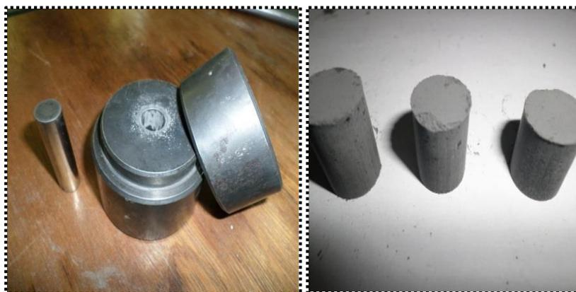
**Figure IV.8 :** Poinçon matrice (à gauche) et échantillons crus (à droite)
