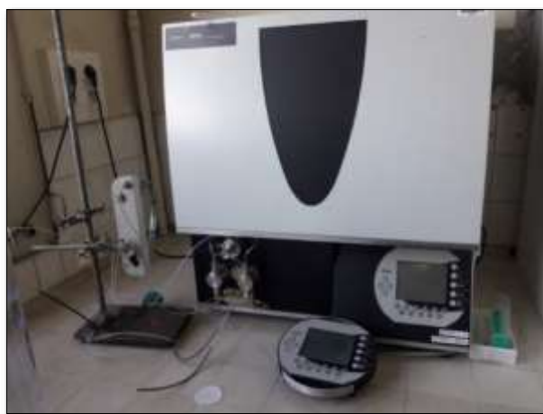
Figure 21 : Chromatographie de partage centrifuge modèle rotor 250 mL et 1L (Armen instrument SCPC-250+1000-B et collecteur de fractions BUCHI-684).
