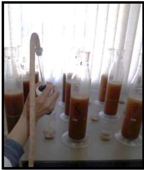
Figure 65 : Séparation de la suspension limono-argileuse par la pipette de robinson (BNEDER).
