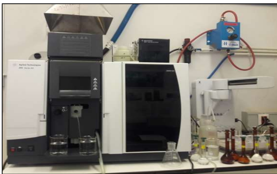
Figure 13 : Spectrométrie d'absorption atomique SAA (C.R.A.P.C).
