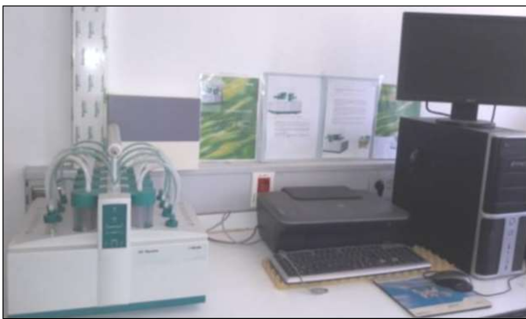
Figure 12 : Photo de l'équipement Rancimat 743 (C.R.A.P.C).
