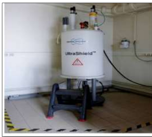
Figure 25 : Spectromètre de RMN Bruker Avance III HD 400 MHz.
