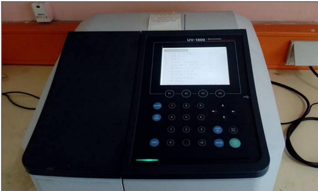
**Figure II.9 :** spectrophotomètre double faisceau Shimadzu UV-1800.
