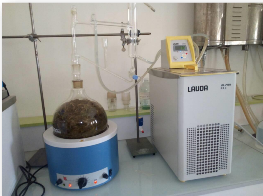
Photo 04 : Montage de l'hydrodistillateur de type Clevenger.
