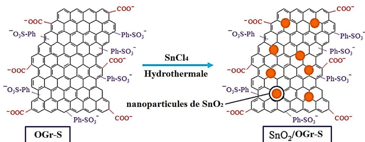
Figure I.20. Schéma illustre la modification d'OGr-S par des nanoparticules de  $\text{SnO}_2$  [139]
