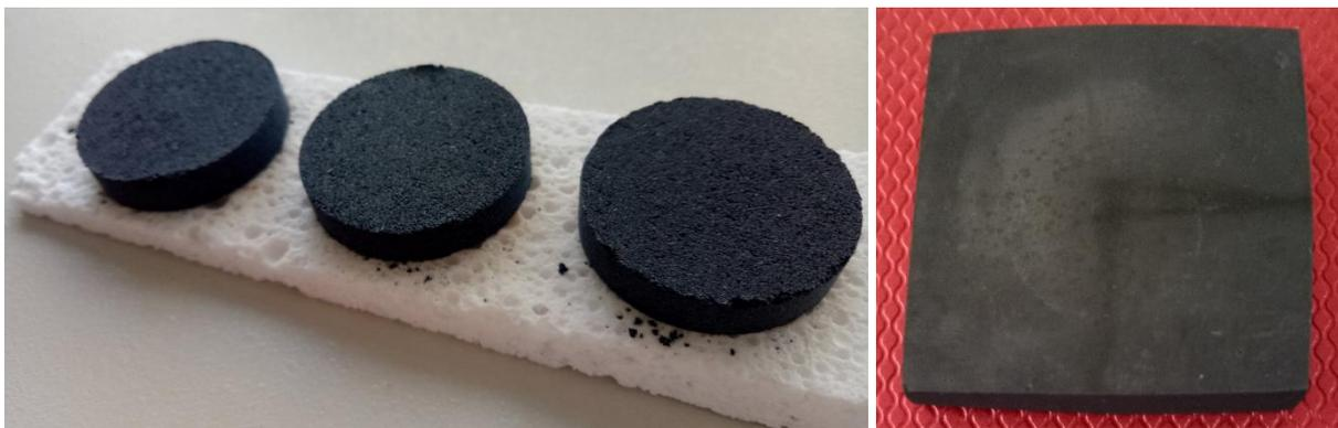
**Figure III.34** — À gauche, pastilles préparées des échantillons proposé comme référence du carbure de silicium (SiC), à droite, carbone pure (C).
