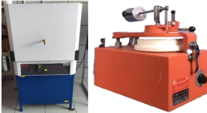
**Figure III.6** — Four électrique de la deuxième fusion et broyeur à mortier utilisés.
