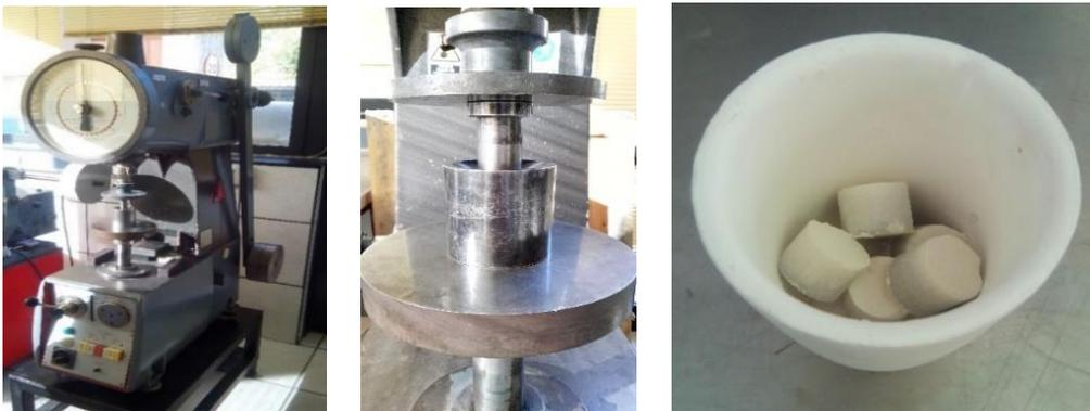
**Figure III.2** — Presse hydraulique verticale et outils utilisés pour la compression de la poudre du mélange.
