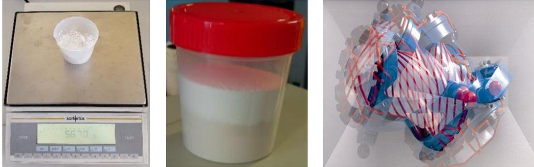
**Figure III.1** — Pesage des différentes poudres du mélange et mixage dans le mélangeur Turbula.
