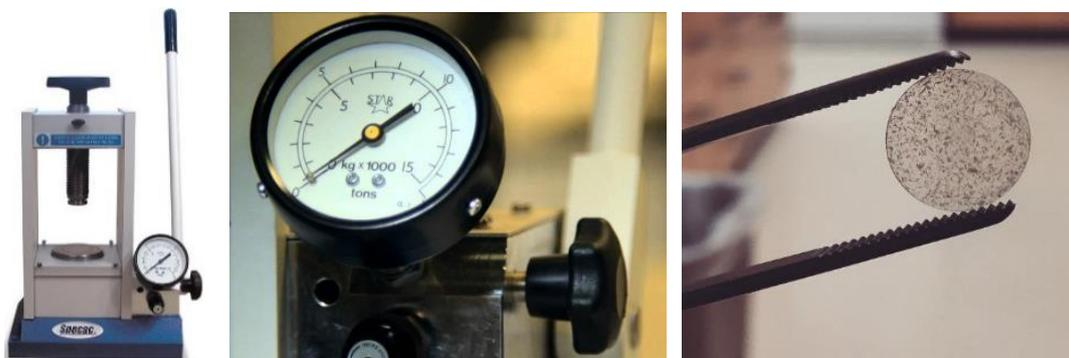
**Figure III.15** — À gauche, presse hydraulique sous vide utilisée, à droite, disque pressé ( $KBr + Verre$ ).
