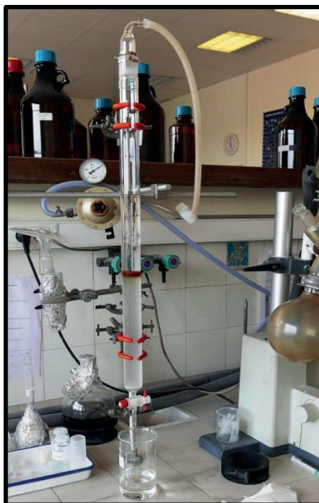
Figure 35 : Montage d'une chromatographie sur colonne "flash"
