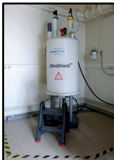
Figure 40 : Spectromètre de RMN Bruker Avance III HD 400 MHz
