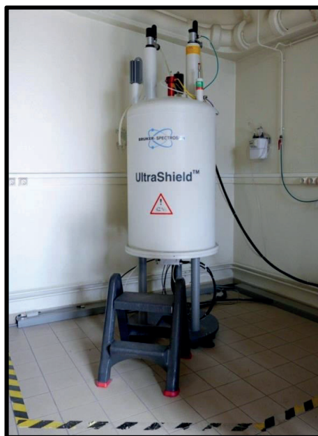
Figure 27 : Spectromètre de RMN Bruker Avance III HD 400 MHz
