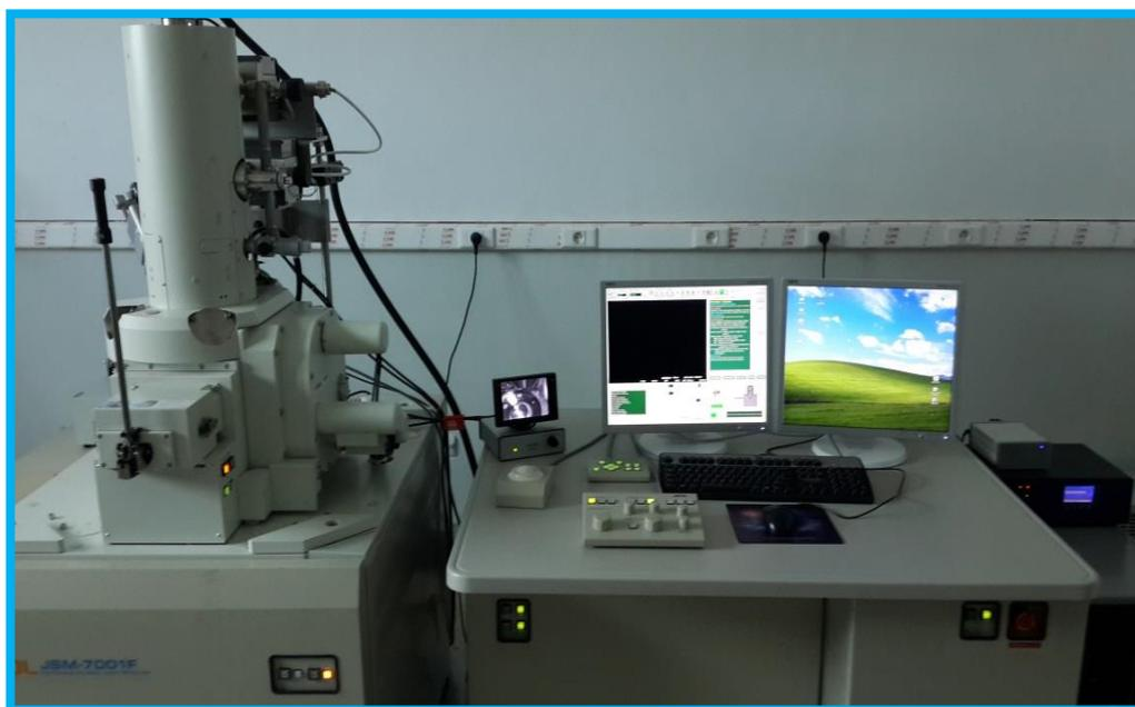
*Figure III.13 Photographie du Microscopie électronique à balayage.*
