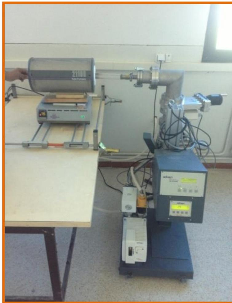
Figure III.6 Photographie du four à recuit sous vide.
