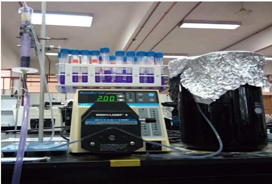
Figure II.5: Dispositif expérimental pour l'étude de l'adsorption du Crystal violet sur lit fixe.
