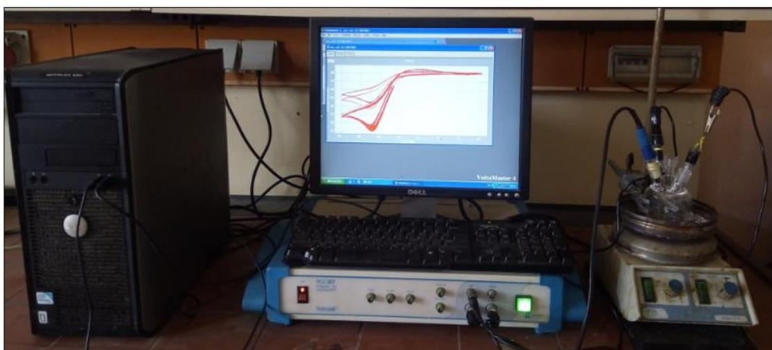
**Figure II. 5.** Montage expérimental utilisé pour les mesures voltampérométriques
