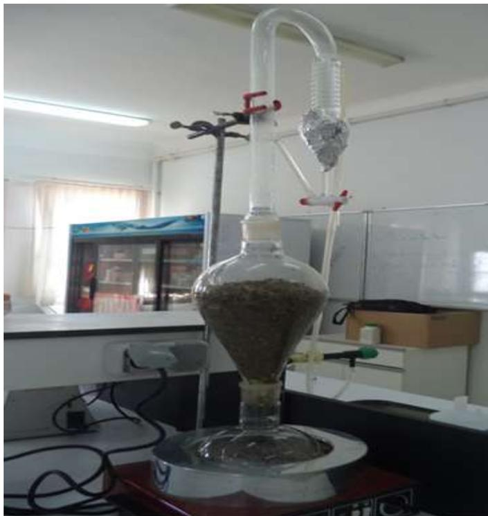
**Fig. 12:** Montage utilisé pour l'extraction des huiles essentielles.
