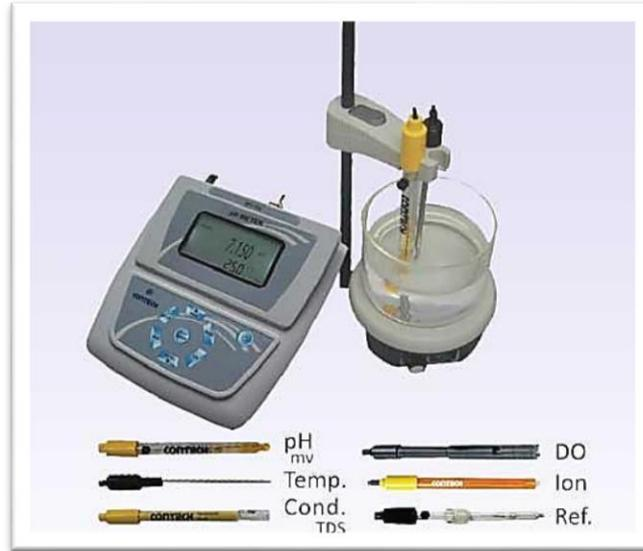
الشكل 7: جهاز قياس درجة الحموضة (www.contechweighingscales.com)
