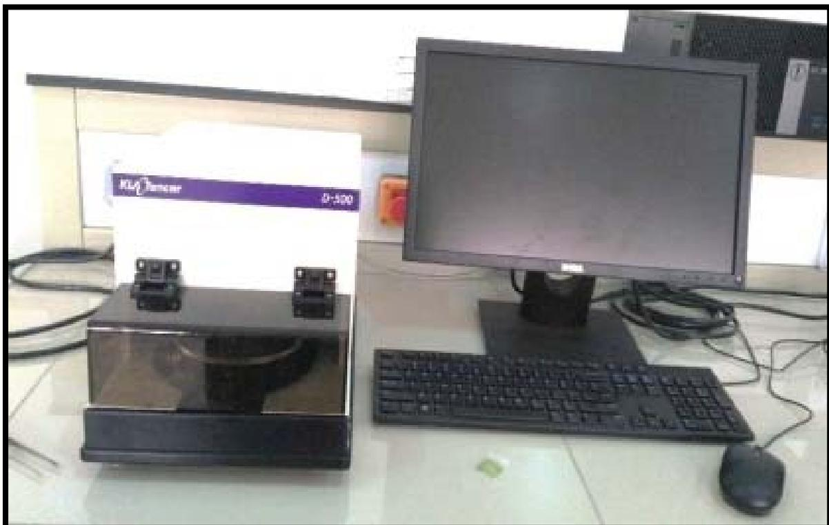
Figure III.15. Profilomètre mécanique de l'unité URME, Université Ferhat ABBAS Sétif1.
