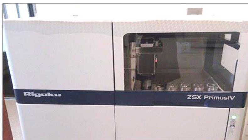
**Figure 3. 6:** Le spectromètre de fluorescence X.
