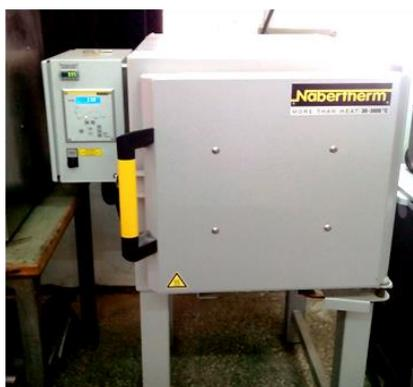
**Figure 3. 3:** Four électrique utilisé pour les traitements thermochimiques des échantillons.
