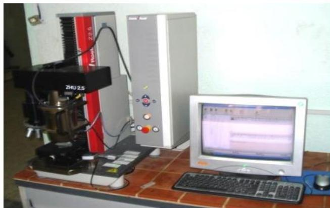
**Figure 3. 4:** Duromètre ZHU 2.5.
