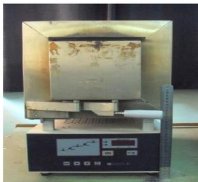
**Figure 3. 2:** Four électrique utilisé pour le recuit des échantillons.
