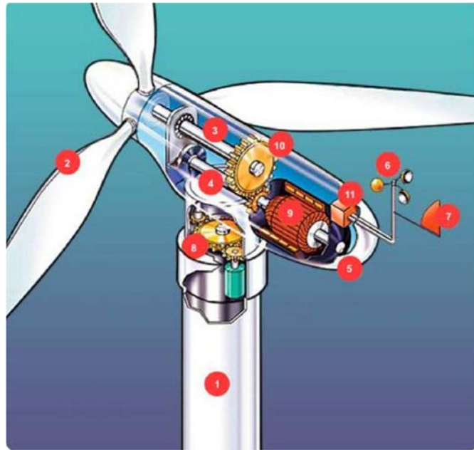
Figure II.11: Principaux composants d'une éolienne [47].
