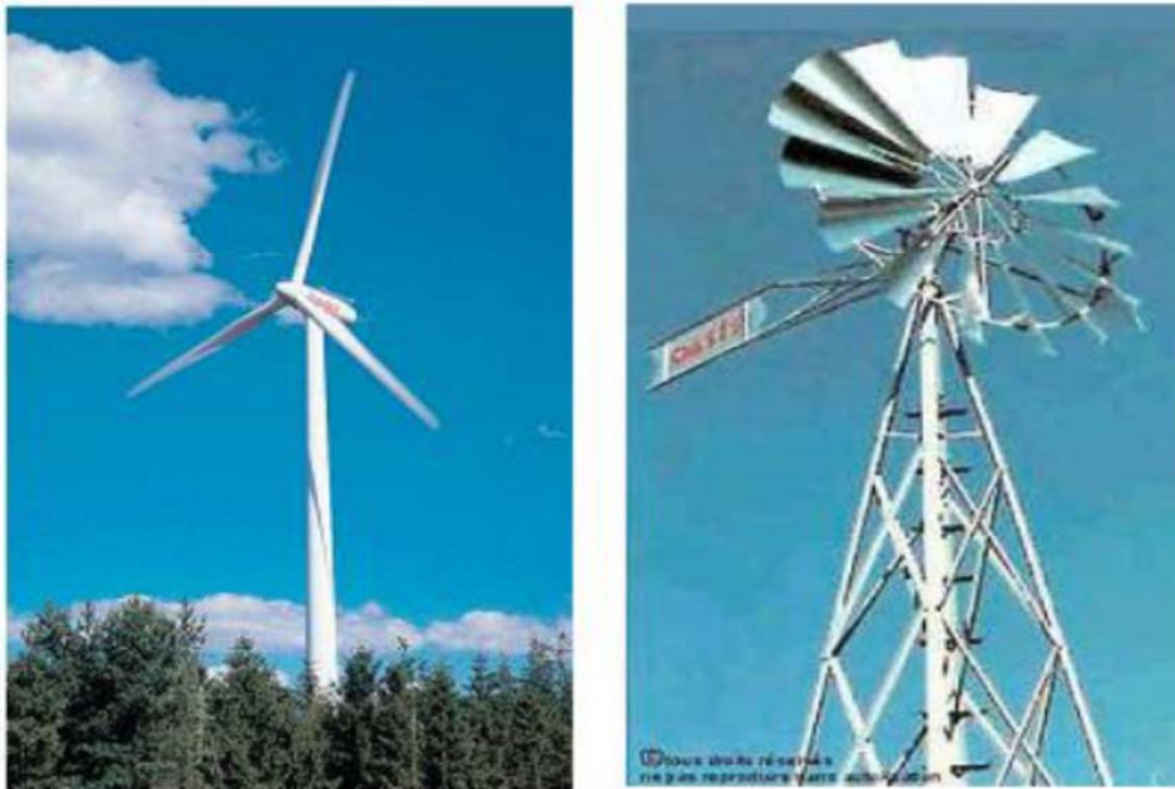
Figure II.10 : Éoliennes à axe horizontal
