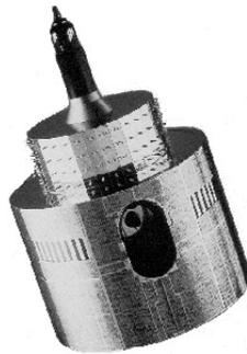
FIGURE 1.1 Le satellite METEOSAT de première génération (MFG)
