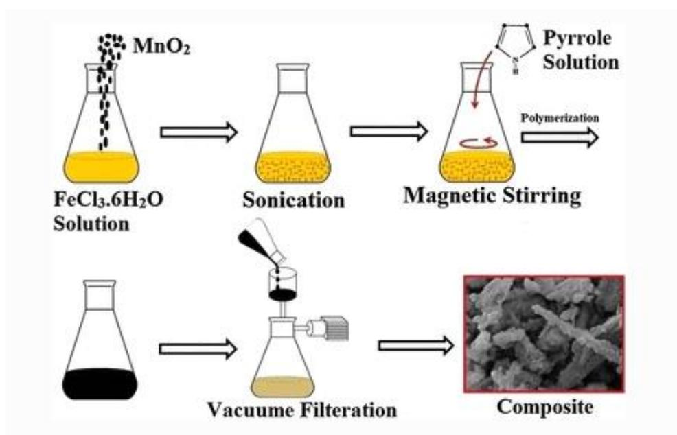
**Schéma 4** : Procédure de synthèse chimique du composite.
