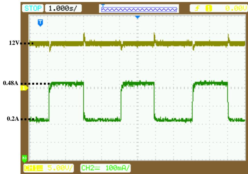
Figure IV.21 Evolution du courant de l'inductance et de la tension de sortie
