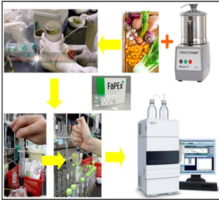
الشكل 5. مراحل استخلاص، تنقية و تقدير تركيز متبقيات المبيدات في المحاصيل الزراعية بواسطة جهاز الكروماتوغرافيا
