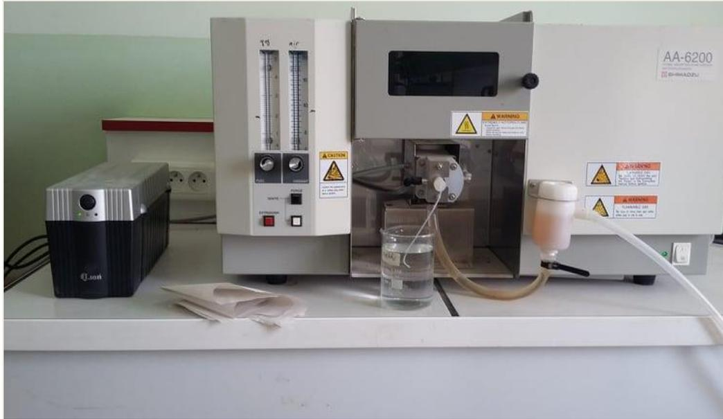
**Figure 20:** Spectrophotomètre d'Absorption Atomique avec Flamme AA6200 (SAAF)
