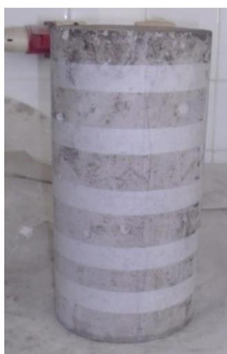
*Figure IV.4. Exemple de traçage de position des bandes PRFC*
