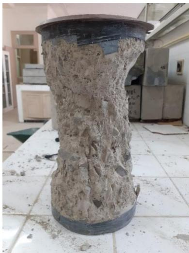
Figure IV.6. Mode de rupture conique
