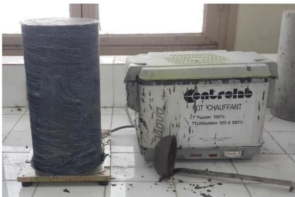
Figure VI.7. Surfaçage d'éprouvette au soufre
