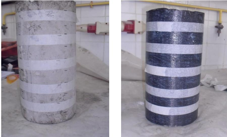
Figure VI.4. Traçage et positionnement des bandes CFRP
