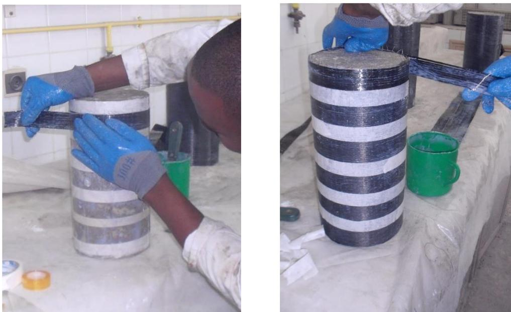
Figure VI.6. Techniques de confinement des éprouvettes par PRFC
