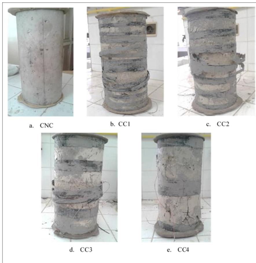
**Figure V.3.** Modes de défaillance des échantillons - les cinq séries CNC, CC1-CC4.
