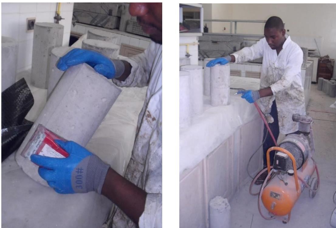
*Figure VI.3. Préparation de surface latérale des éprouvettes (nettoyage et dépoussiérage)*
