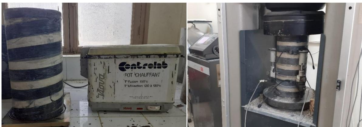
Figure IV.2. Surfçage des éprouvettes, et montage des LVDTs
