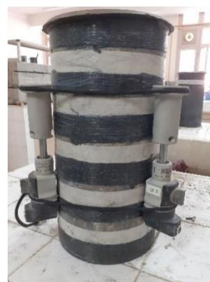
Figure VI.8. Montage des LVDTs
