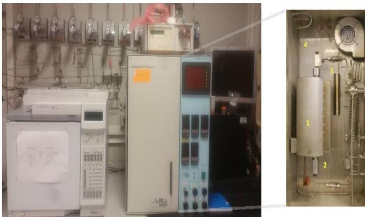
**Figure II.9:** Réacteur utilisé pour l'oxydation du CO.
