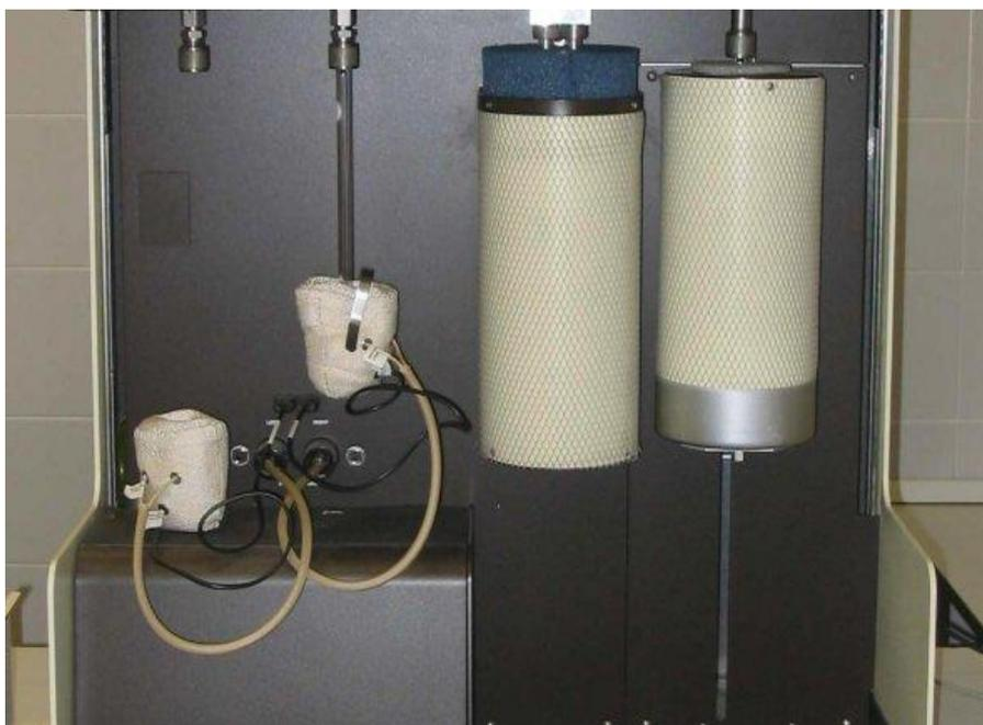
**Figure II.16:** *Mesure de l'aire spécifique (BET).*
