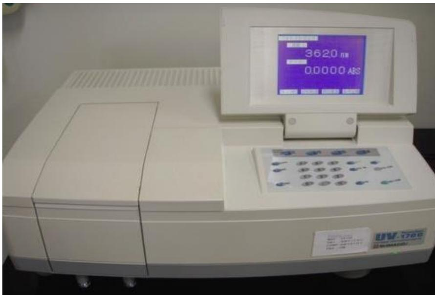
***Figure II.13:*** Spectrophotomètre SHIMADZU UV-1700.
