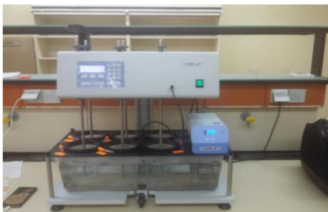
**Figure II.13.** Montage de dissolu test.
