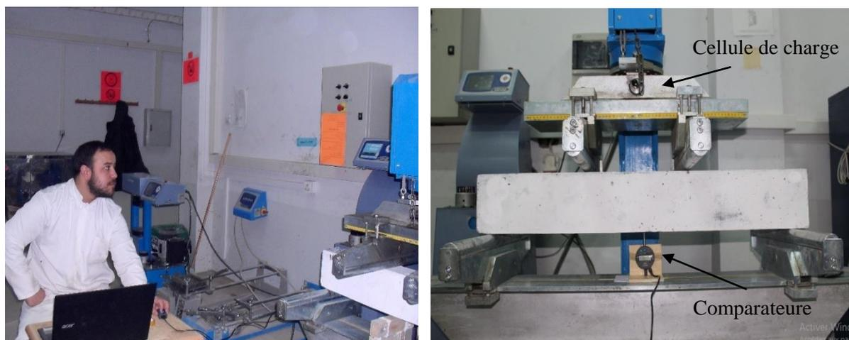
**Figure IV. 5 :** Dispositif d'essai adoptée pour les essais de flexion.
