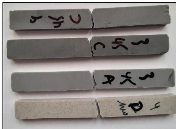
**Figure III.7 :** Modes de rupture obtenus pour les différents échantillons de résine.
