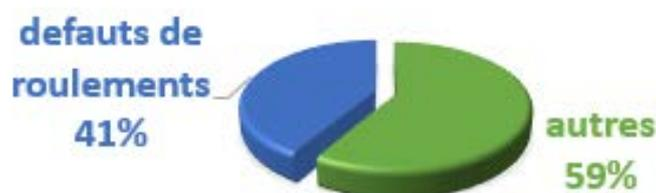
Figure II.5. Pourcentage % des causes des défaillances dans les machines tournantes
