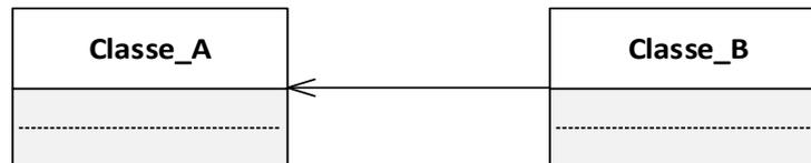
Figure IV.3. Structure de l'association navigable dans une direction en UML
