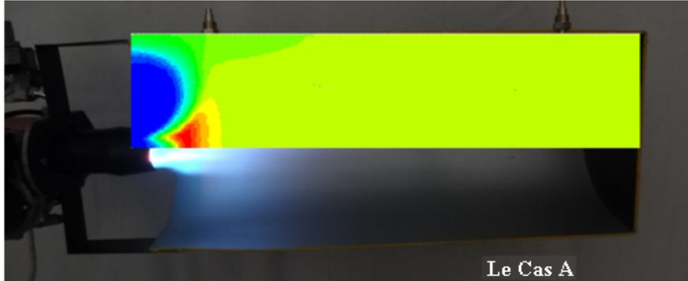
FIGURE 6.16: Comparaison entre la photo expérimental et le contour de la température /Cas A.
