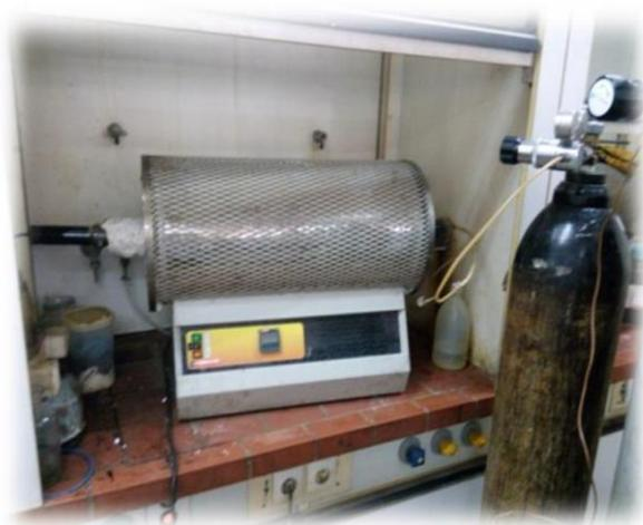
**Figure II.4:** Montage utilisé pour la carbonisation.
