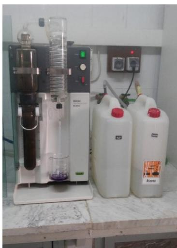
**Figure 42.** Unité de distillation (Kjeldahl).
