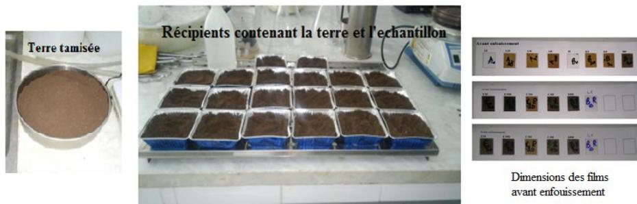
Figure 45. Mise en enfouissement dans le sol.
