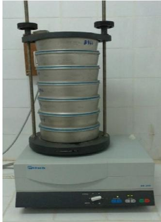
**Figure 28.** Tamiseuse vibrante.
