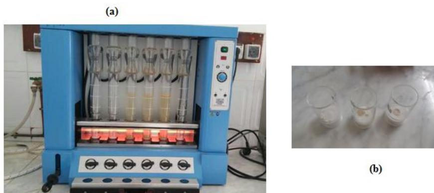
**Figure 36.** a) Fibertest (6postes) ; b) Résidu cellulosique.
