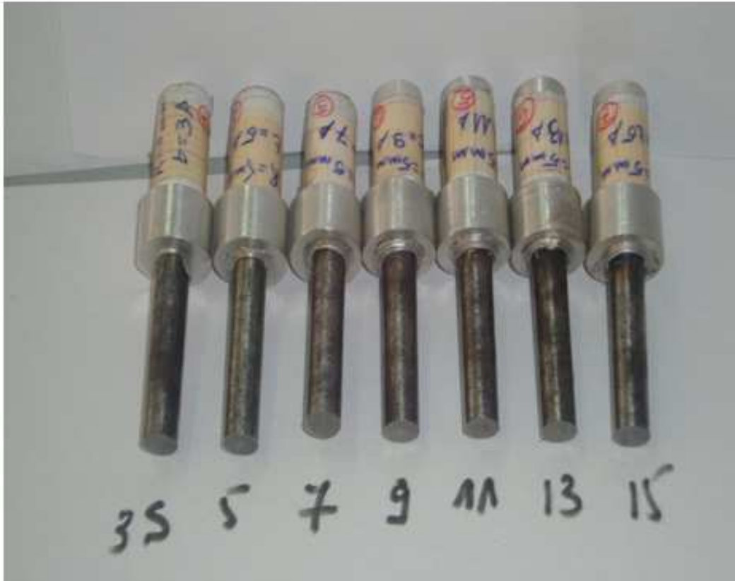
Figure IV.24 Exemple de pièces soudées par friction (soudure dissemblable Acier/Aluminium)
