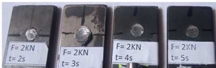
Figure IV.32 Points de soudure par friction de l'assemblage dissemblable tige - plaque après test de cisaillement
