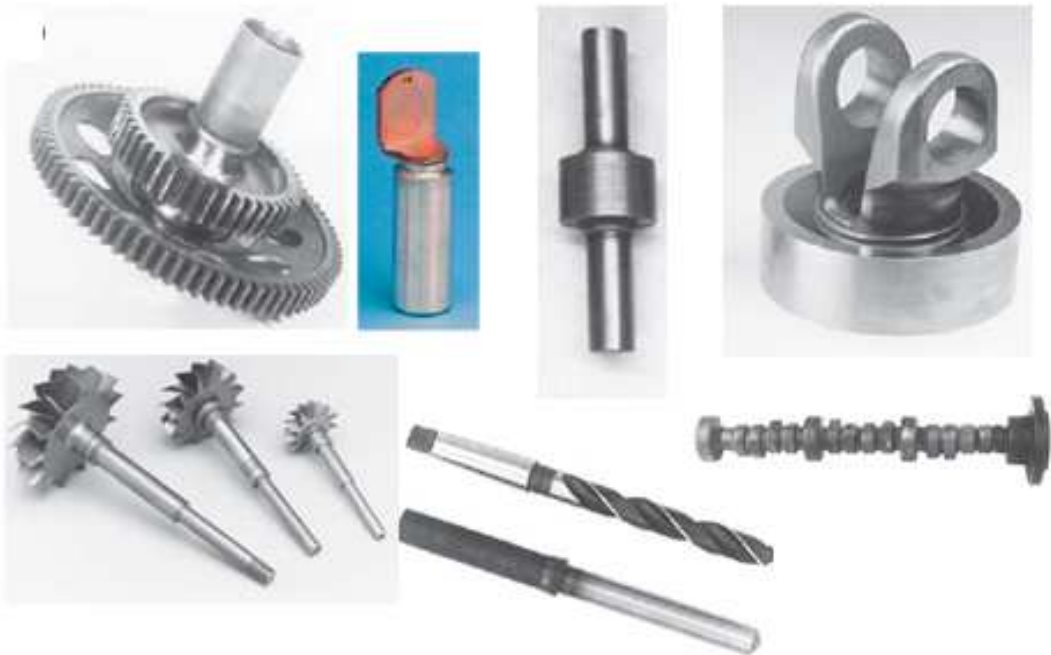
Figure I.6 Exemples de pièces soudées par friction rotative [76]
