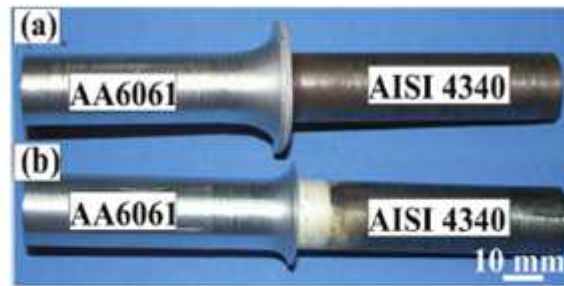
Figure I.28 Macrographie d'une soudure par friction entre un alliage d'Al (AA6061) et un acier (AISI 4340) (a) Sans couche intermédiaire, (b) avec couche intermédiaire [41]
