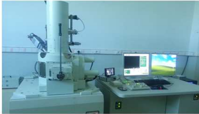
Figure III.12 Microscopie électronique à balayage (MEB) type JOEL-Model JSM-7001F, Japan
