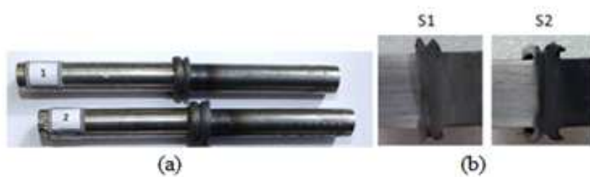
Figure I.21 Photos d'échantillons soudés par friction à différentes conditions (acier inox AISI 2205 et AISI 1020) [33]
