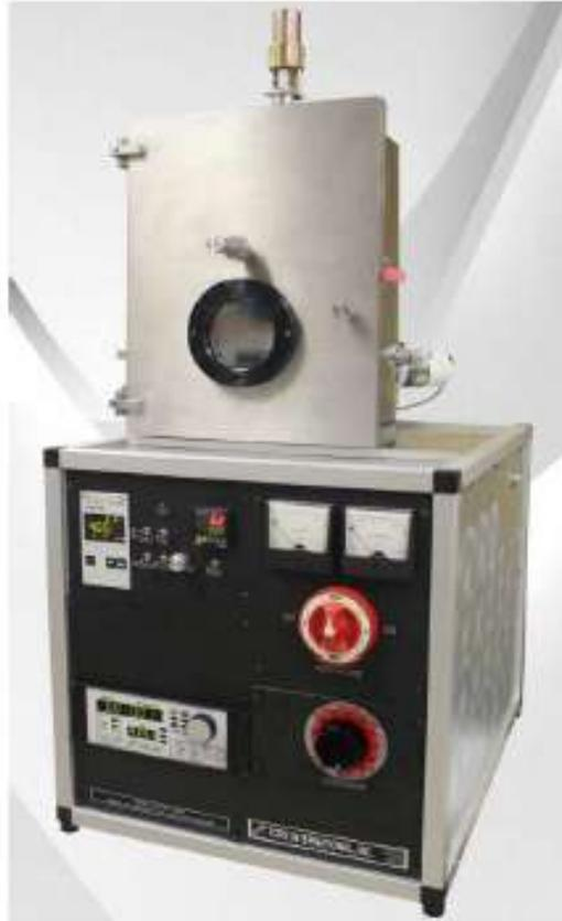
**Figure (III.3) :** Photographie de l'évaporateur thermique sous vide (laboratoire LEM de l'université Ferhat Abbas de Sétif-1).
