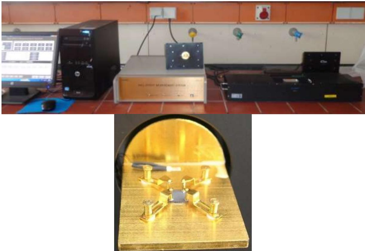
**Figure (III.14) :** (a) Appareillage des mesures électriques par effet Hall Modèle HMS-5300 (laboratoire LEM de l'université Ferhat Abbas de Sétif-1); (b) Porte échantillon.
