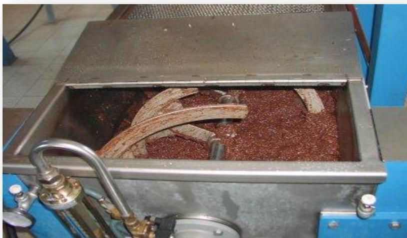
Figure n°09 : Photo d'un malaxeur dans une huilerie.
