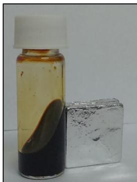
**Figure II. 1.** Photo correspondante au ferrofluide citraté préparé.
