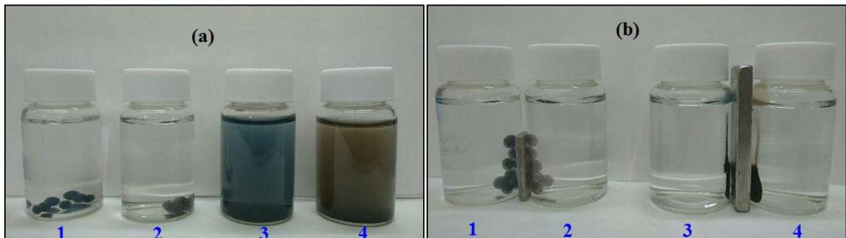
**Figure II. 3.** Photo correspond aux matériaux préparés : billes A/Sep/NP/BP (1) ; billes A/Sep/NP (2) ; Sep/NP/BP (3) ; Sep/NP (4) avant (a) et après (b) séparation magnétique.
