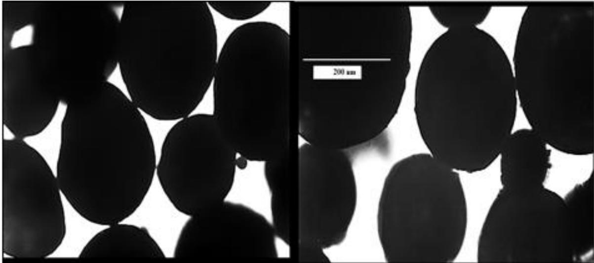
**Figure II.2.2:** Photo des microsphères prise par microscopie optique pour F2
