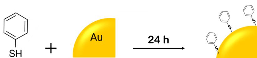
FIGURE. 6.1– Interaction covalente (S-Au) entre la surface de la nanoparticule d'or et le thiophénol.
