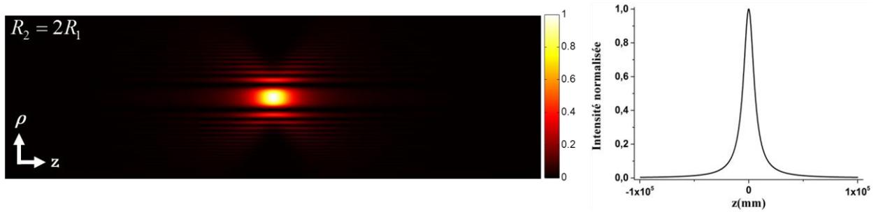
FIGURE. 4. 11 – Profils de l’intensité axiale correspondant aux franges d’interférences de deux faisceaux gaussiens illustrant l’effet de la variation du rayon de courbure.
