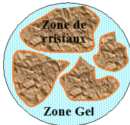
Figure E18 : Structure des zones de la masse active.
