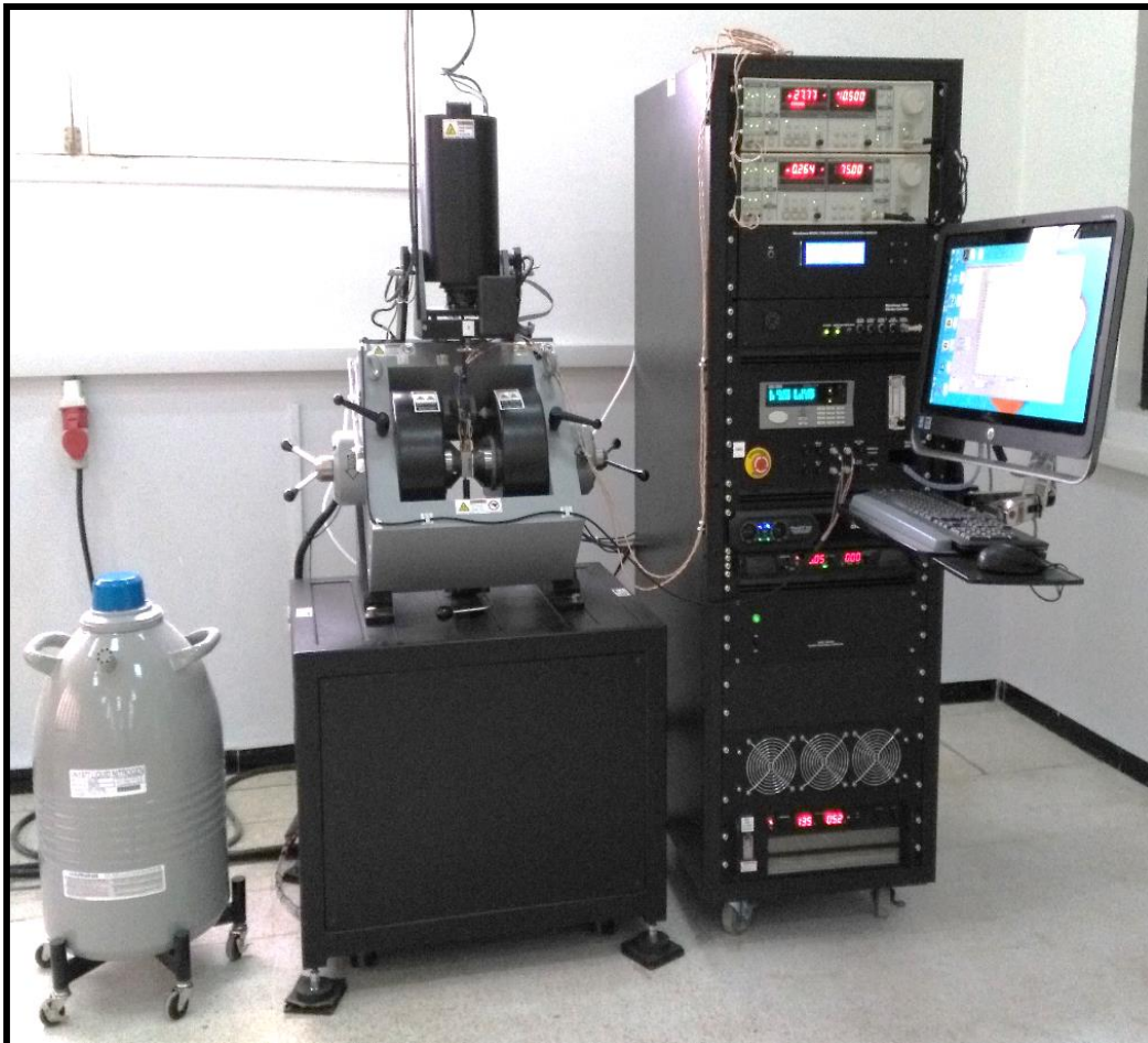
Figure III.14. Magnétomètre à échantillon vibrant (VSM) de l'unité de recherches de matériaux émergents (URME), Université Ferhat ABBAS Sétif1
