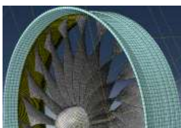
Fig. 4 : Présentation du maillage utilisé pour la simulation de l'interaction aube/abradable.
