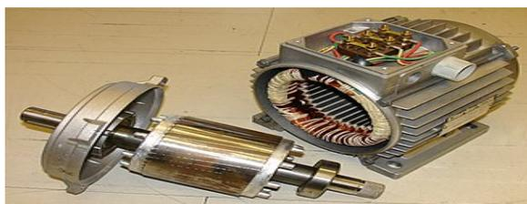
FIGURE A.2 – *Rotor et stator de la MAS*
