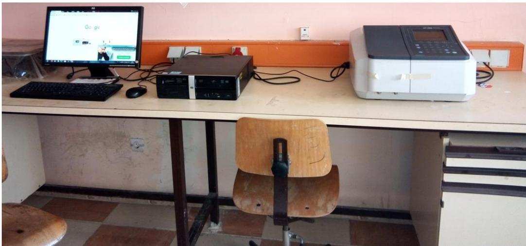
**Fig.II.13** : Spectrophotomètre UV-visible de type UV-1800 PC SHMADZU.
