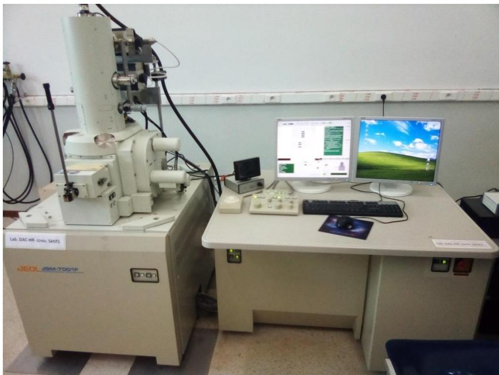
**Fig.II.10 :** Le microscope électronique à balayage Jeol JSM-7001F.
