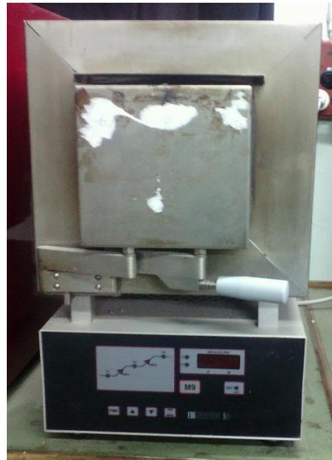
**Fig.II.5** : Etuve et four utilisés pour le séchage et le recuit des échantillons élaborés.
