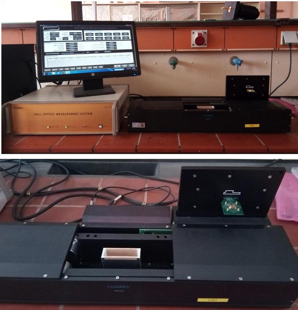
**Fig.II.15** : Système de mesure Effet Hall ECOPIA HMS-5300 Ver5.8.0.7.
