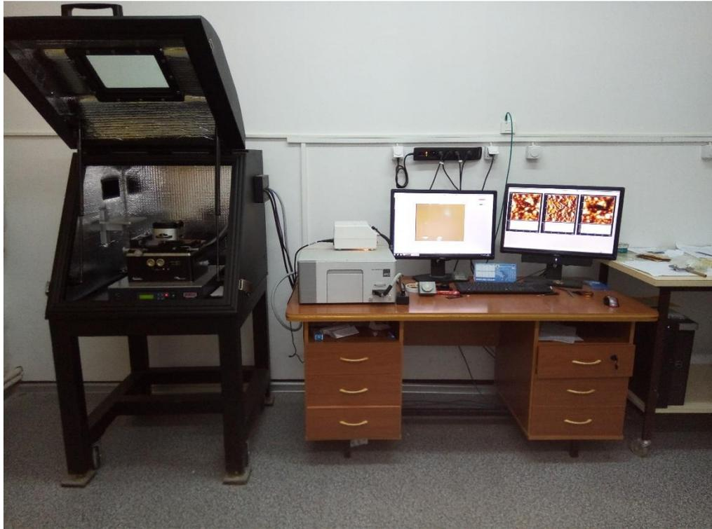
**Fig.II.12** : Microscopie à force atomique Asylum Research MFP-3D.
