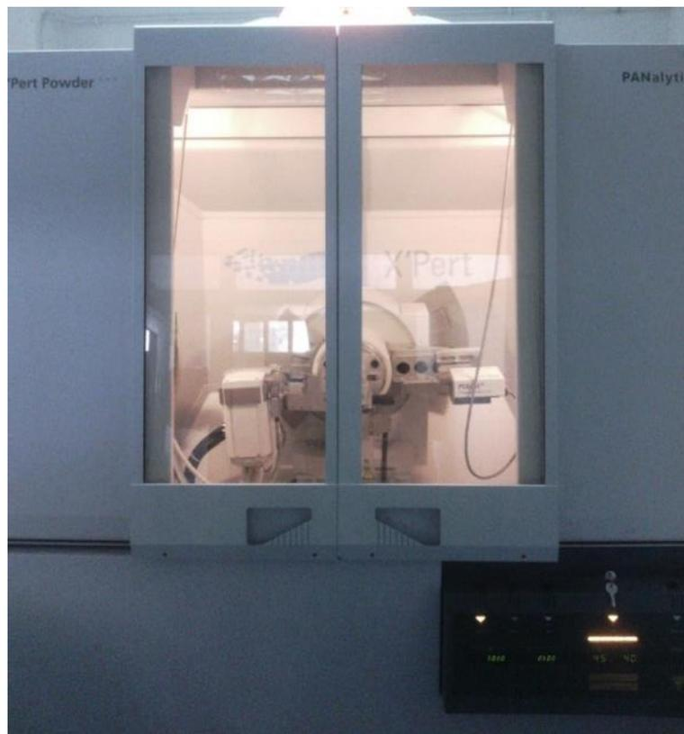
**Fig.II.8** : Diffractomètre X'PERT Powder.
