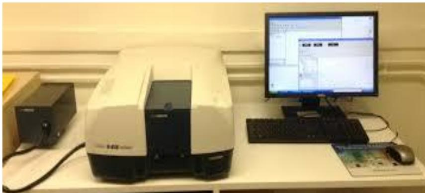
Figure IV.18 : Spectrophotomètre (UV-Vis/NIR V-670, Jasco).
