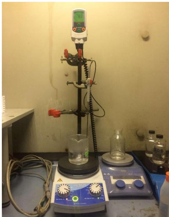
**Figure IV.2 :** Plaque chauffante à agitation magnétique munie d'une sonde de température.
