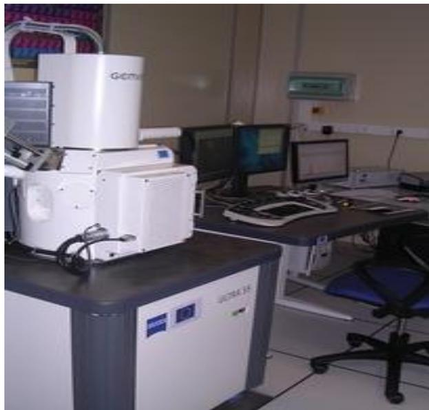
**Figure IV.10 :** Microscopie électronique à balayage (MEB) de type SUPRA 55 VP.
