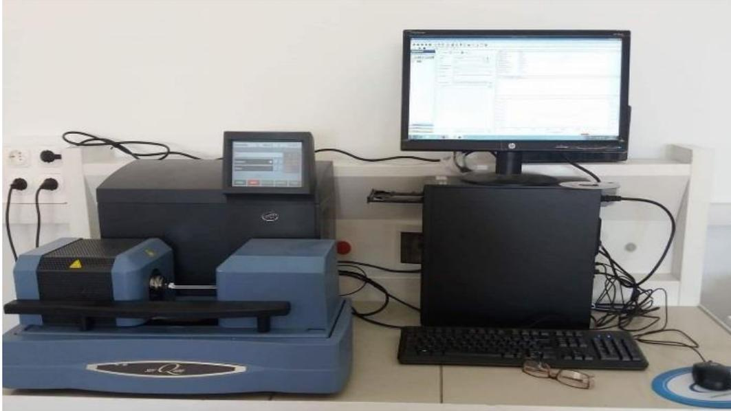
**Figure IV.6 :** Appareil de mesure d'ATD (DSC) et ATG utilisé (SDT Q600, TAinstrument).
