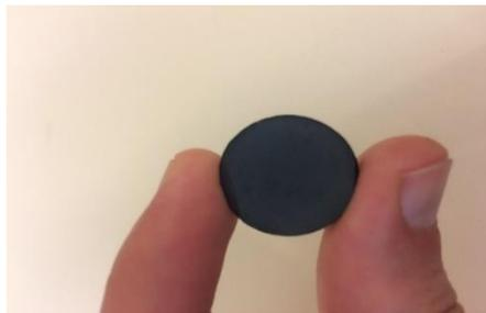
**Figure V.12** : Echantillon spinelle fritté à 1310 °C par SPS.
