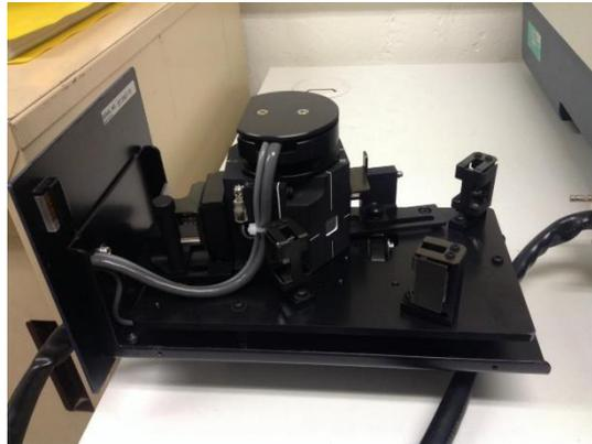
**Figure IV.20** : Sphère intégrante associée au spectrophotomètre Jasco 600.
