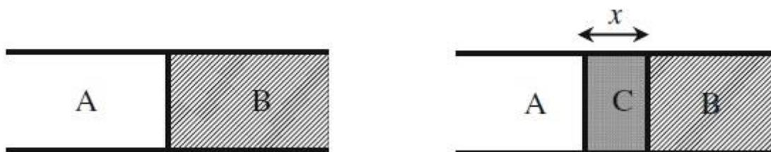
**Figure II.1** : Schéma de la réaction à l'état solide entre deux monocristaux (A et B) [Barr 13].
