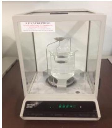
**Figure IV.25 :** Montage de mesure de densité apparente utilisé.
