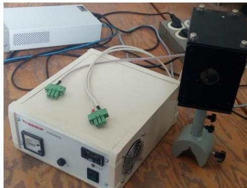
Figure II.2 : Lampe et source d'alimentation.
